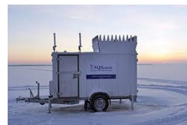
Système de mesure de vent SODAR
